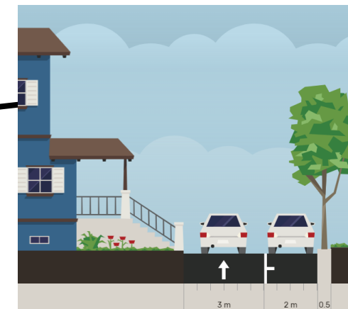
Preliminarus Vijoklių g. skersinis profilis, numačius vienpusį eismą ir leidžiant stovėti TP vienoje gatvės pusėje (skersiniame profilyje važiavimo kryptis parodyta nuo J.Janonio g.)
