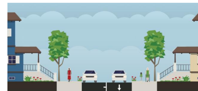
Preliminarus žiedinio eismo gatvės skersinis profilis, numačius vienpusį eismą ir leidžiant stovėti TP vienoje gatvės pusėje
