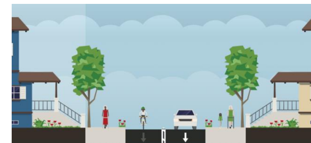
Preliminarus žiedinio eismo gatvės skersinis profilis, numačius vienpusį eismą bei pėsčiųjų ir dviračių zoną
